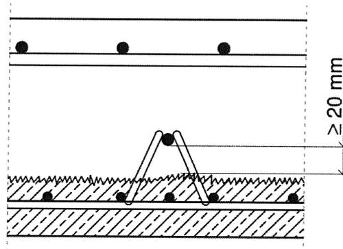
**Bild 5: Gitterträger als Verbund- und Querkraftbewehrung (mäßige Beanspruchung)**
